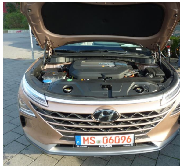
Die großen Lufteinlässe werden auch benötigt, um die Temperatur der Brennstoffzelle zu regeln
