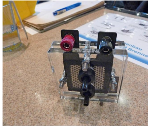
einfache reversible PEM- Brennstoffzelle zum Auseinandernehmen
